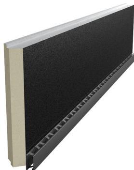
Il Sistema ISOTEC PARETE BLACK - pannello strutturale isolante per la realizzazione di facciate ventilate, composto da un'anima isolante in schiuma di poliuretano rigido autoestinguente ricoperta da un coating minerale ignifugo e reso portante da un profilo nervato in acciaio - è prodotto in conformità alle seguenti caratteristiche e norme tecniche:
